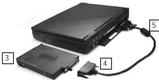
FDD PARALLELE AANSLUITING AFB. 3 – 8
